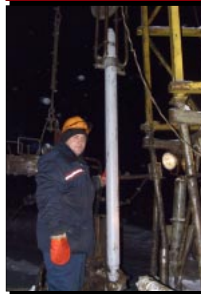
Рис. 2. Монтаж погружного вентильного электродвигателя серии ВЭДБТ
